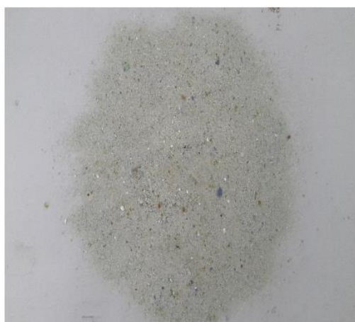
Figura 11 – a) Resíduo de vidro e b) Forma das partículas do resíduo de vidro Fonte: Bisht & Ramana (2018)
