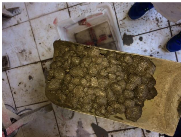
Figura 20 – Aspecto do concreto que não houve homogeneização do agregado miúdo natural com RMN.
